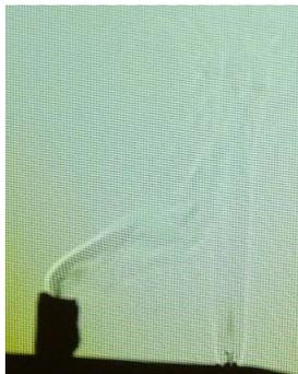
**Fig.5.** Immagine delle correnti quando una delle fiamme è perturbata con un movimento della mano
