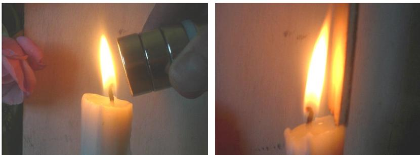
**Fig.10.** Flessioni a sinistra e a destra della fiamma: azione magnetica e meccanica
